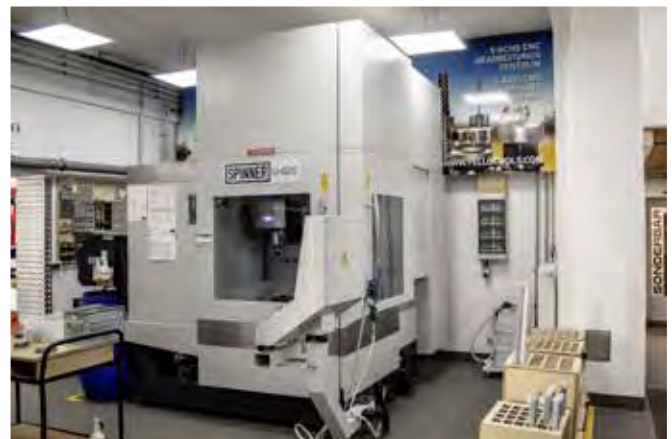
Mit der fünf-achsigen CNC-Fräse kann Yellotools komplexe Bauteile einfach und kostengünstig herstellen.
