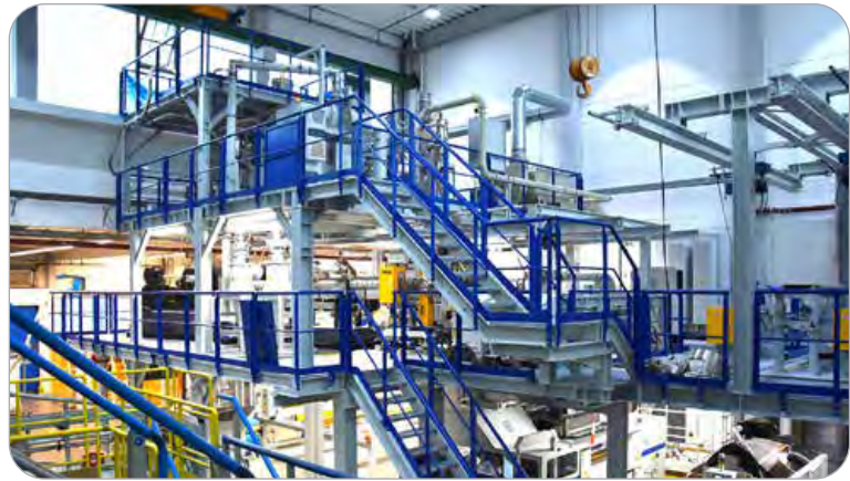
Fünf Million Euro Invest, vier Etagen hoch und bestückt mit modernster Technik. Die neue PET-Extrusionsanlage gebaut von der Firma Reifenhäuser.
