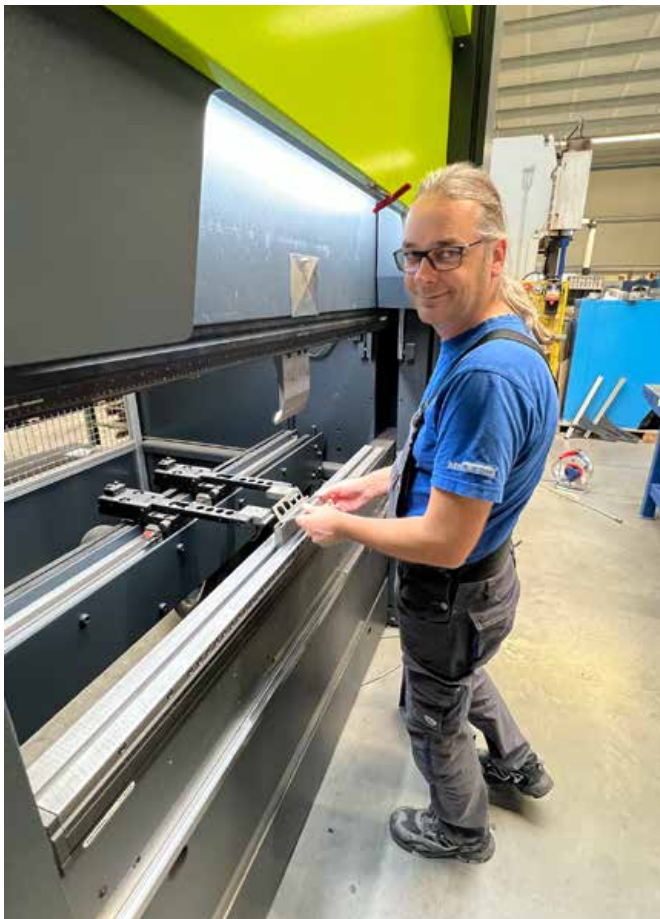
Die Abkantpresse bei Rhein-Blech verfügt über ein Hydraulikaggregat und erzeugt einen Pressdruck von 220 Tonnen. Dazu ist sehr viel Energie erforderlich – deshalb setzt sich Henkes bei der Planung dauerhaft mit Klima- und Umweltschutz sowie Nachhaltigkeit auseinander.
