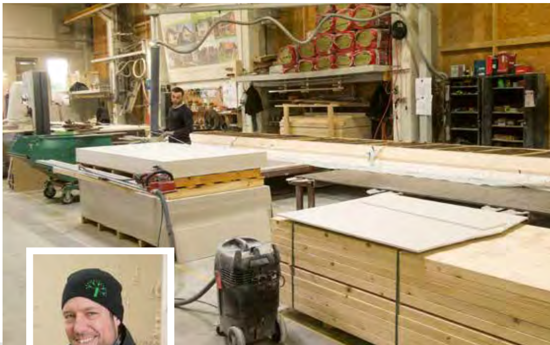
In der Produktion – hier die Halle für die Innenwände – entstehen pro Jahr 60 Holzhäuser. Vom Bedienpult aus steuert Zimmermann Maximilian Wieland (r.o.) die Maschine, die Kanthölzer für einen Dachstuhl schneidet. Lean-Manager Stefan Löttgen (l.) motiviert die Mitarbeiter, die Arbeitsprozesse zu verbessern.
