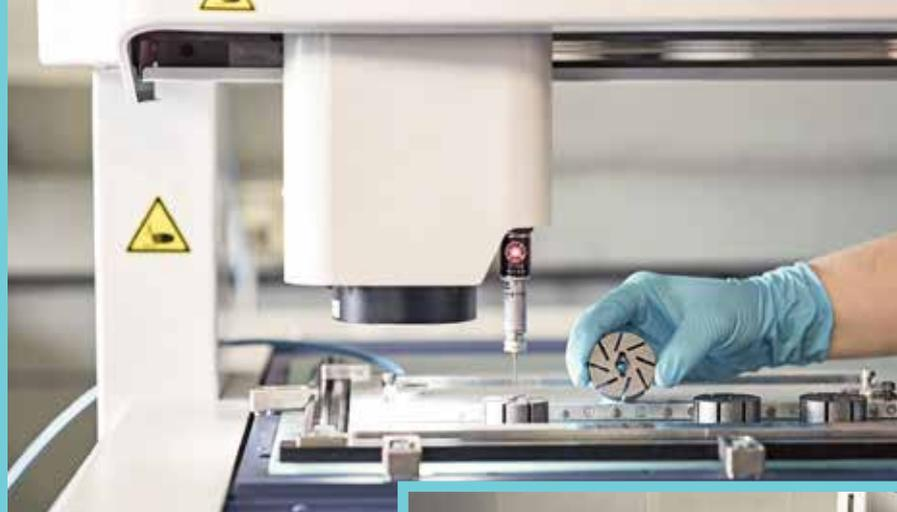
*Graphitkomponenten für die Automobilbranche (oben), Halbleiterherstellung (re.) und mechanische Anwendungen (ganz unten) werden einer strengen Güteprüfung unterzogen. Keine Zukunftsmusik ist der Carbon-Rotor aus dem 3D-Drucker (unten li.).*
