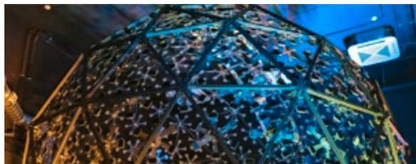
Außenaufnahme der Lightstage: Sie ermöglicht durch eine Vielzahl an Lichtquellen und Kameras die Erstellung hochrealistischer Avatare.
